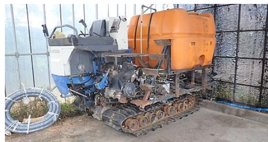
液肥散布用にコンバインを改造した機械
